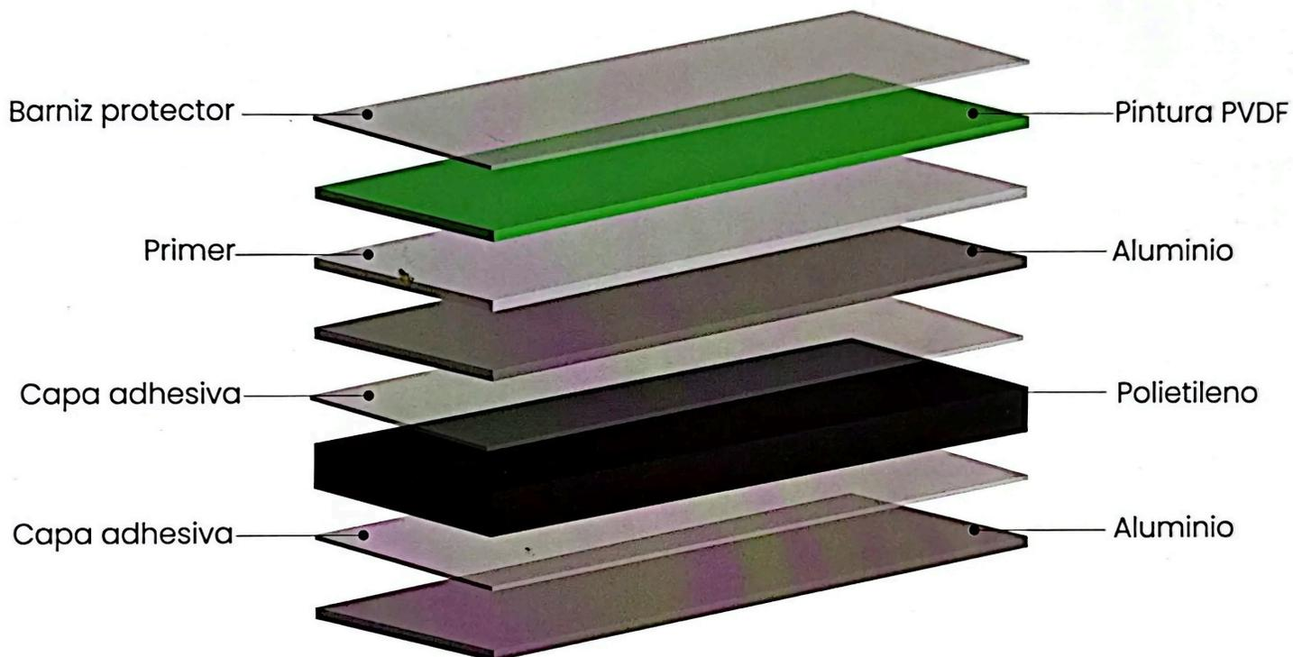
El Panel Compuesto de Aluminio Engebold consta de dos láminas de aluminio y un núcleo de polietileno de baja densidad, laminado a través de un sofisticado proceso de unión que involucra adhesivos químicos a altas temperaturas, con un espesor total de 4 mm.
