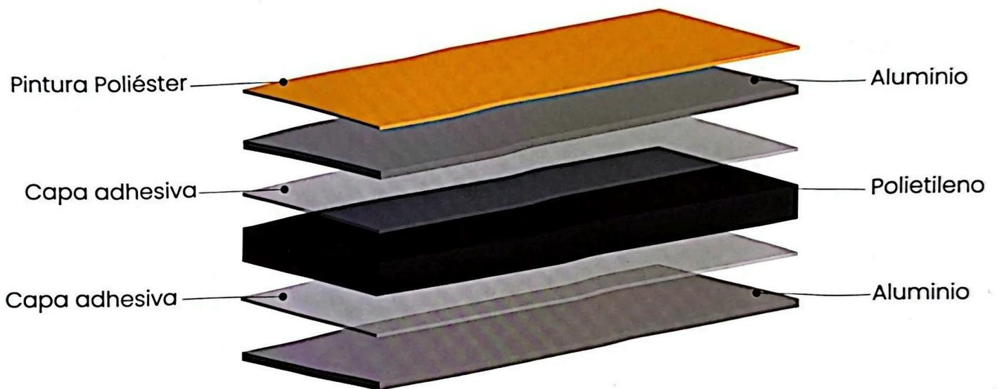
El Panel Compuesto de Aluminio Easybold está compuesto por dos láminas de aluminio y un núcleo de polietileno de baja densidad, laminado mediante un sofisticado proceso de unión que involucra adhesivos químicos a altas temperaturas, con un espesor total de 3 mm.
